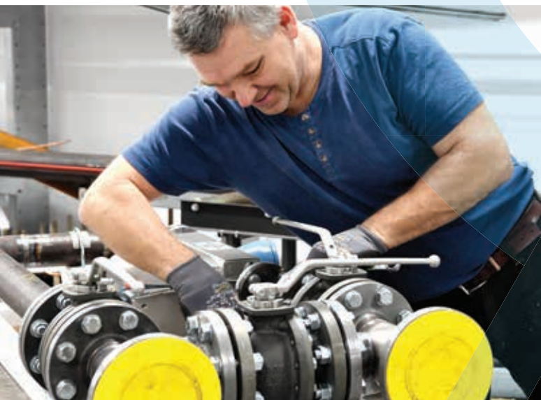
Præfabrikation af bypass system.
