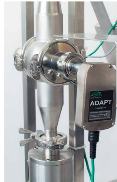
På Compact Perfect Pitch sidder Abers Compact Adapt til måling af kun de levende gærceller samt en flowmåler. Sammen med Mini PLC'en sørges der for, at den korrekte mængde levende gær bliver doseret.
