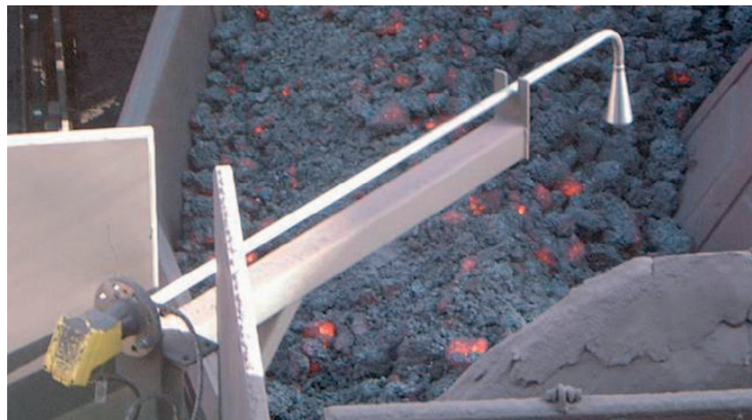
Fig. 3. Radarsensor med antenneforlængelse til måling i varm sinte i stålproduktion.
