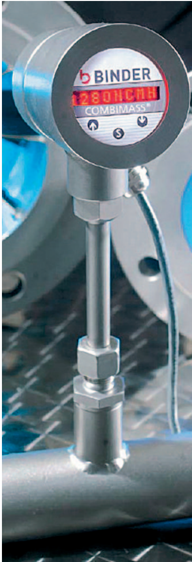
Combimass indstikflowmåler monteres nemt med en klemningsforskruing. Måleren kan fås med hus i rustfrit stål eller aluminium og i henhold til ATEX Zone 1 & 2.
