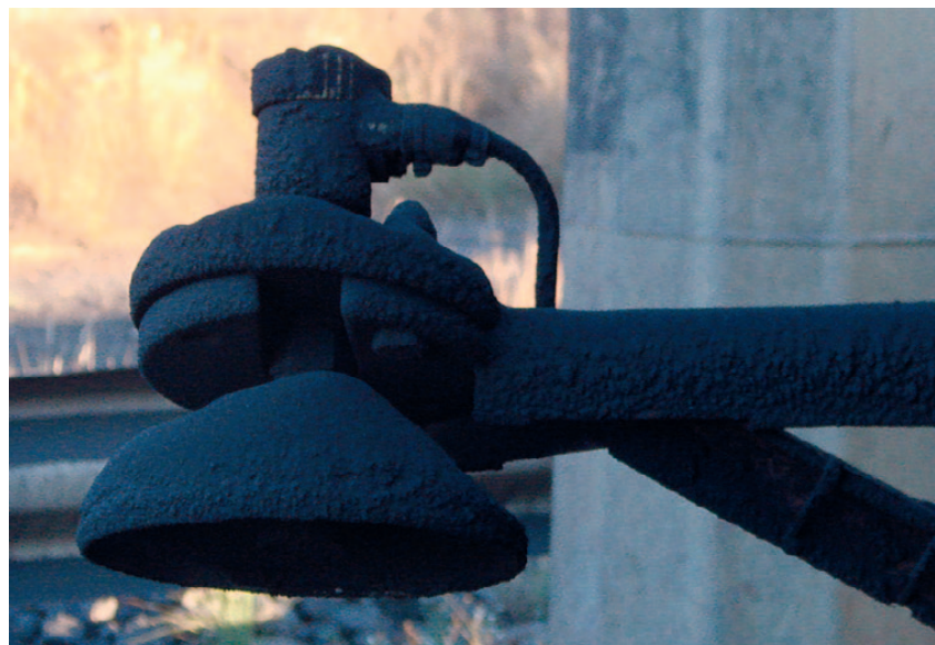
Fig. 4. Radarsensor med parabolantenne til overvågning af kulafleesstation.
