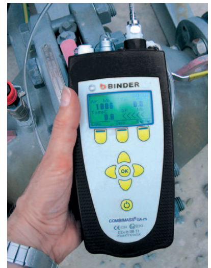
Binders gasanalytator kan bruges både som bærbar enhed og i en dockingstation. Den kan fås med ATEX godkendelse til zone 1 & 2.
