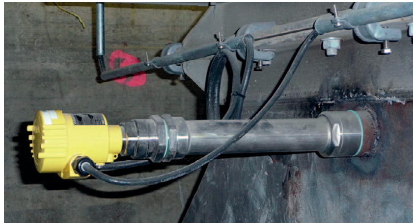
Fig. 2. Mikrobølge barrierer med rørforlængelse som temperaturbarriere i en klinkekøler.
