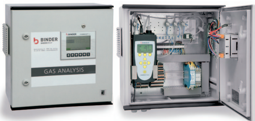
Binders gasanalytator monteret i en dockingstation til kontinuerlig måling. Ved brug i felten, afkobles spændingsforsyning og sampling slange.
