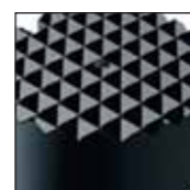
Blackbody kilder med høj emissivitet til 1300°C.
