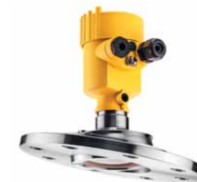
Flangeversionen af VEGAPULS 69 har et kugleled af højkvalitetsstål, hvorved antennen kan justeres til den rette vinkel.
