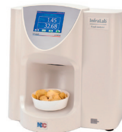
InfraLab-e fra NDC er att-line modellen til hurtig analyse på bare 10 sekunder.
