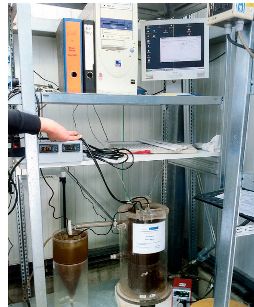
Figur 2. Forsøgsreaktor med procesvand: 4...20 mA udgangssignal direkte fra sensoren anvendes til displayvisning. Der er ikke behov for ekstern transmitter.
