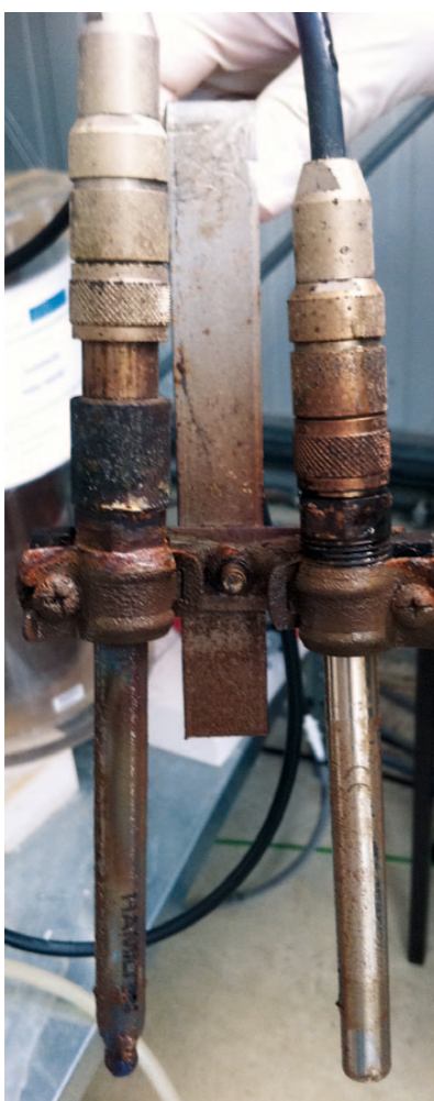
Figur 1 Efter 10 måneder uden justeringer; pHeasy i procesvand. Den organiske forurening kan simpelthen fjernes.
