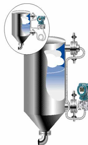
Niveaumåling i lukket tank.
