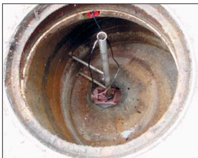
Sonde monteret i 160 mm PVC dræn.
