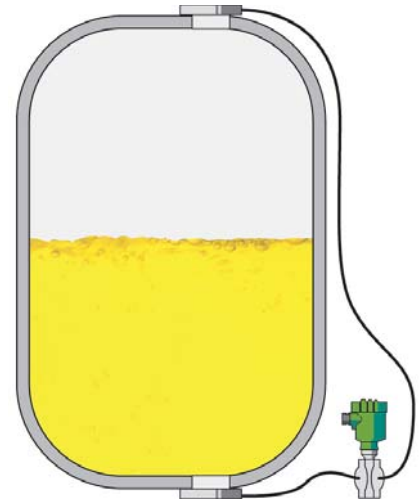
Niveaumåling i lukket tank.
