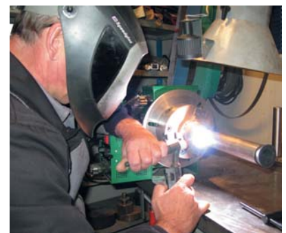
Svejsning af rør ved drejebord.
