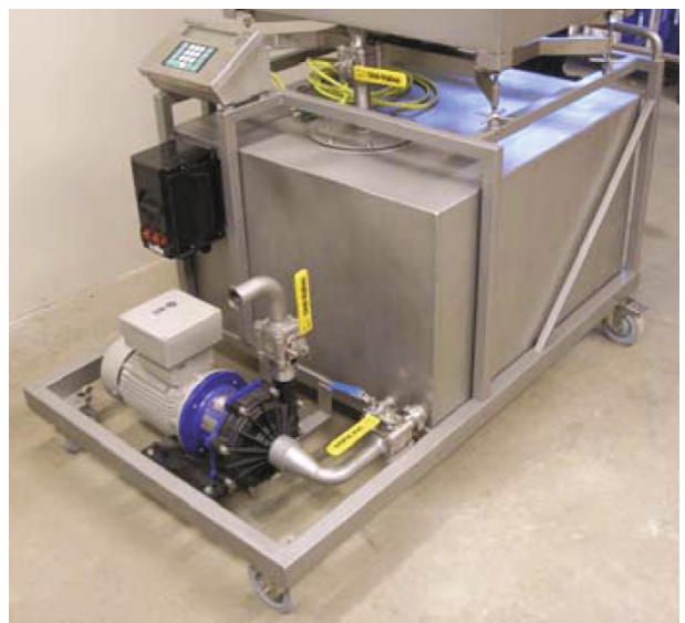
Kalibreringsvogn - vægt som reference
