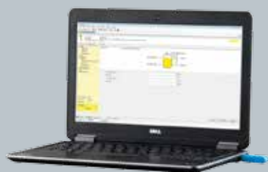
Trådløs justering med PACTWARE og DTM ved brug af Bluetooth USB adapter.
