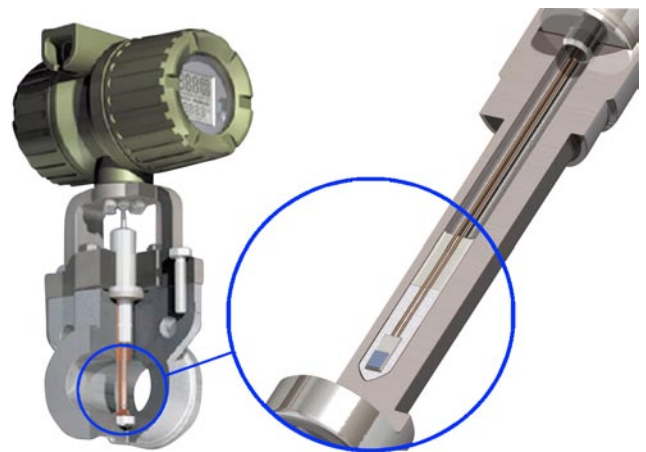
Billedet viser Yokogawa's multivariable vortexmåler med indbygget temperaturføler og flowcomputer for automatisk densitetskompensering.
