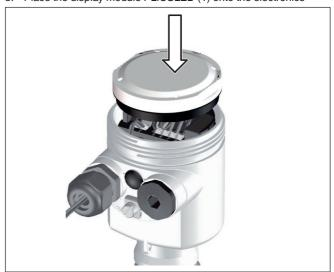
Fig. 3: Insert display module
