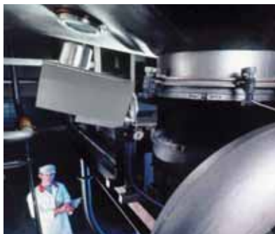
MM710e monteret foran skueglas ind til spraytørrer/fluid bed.
