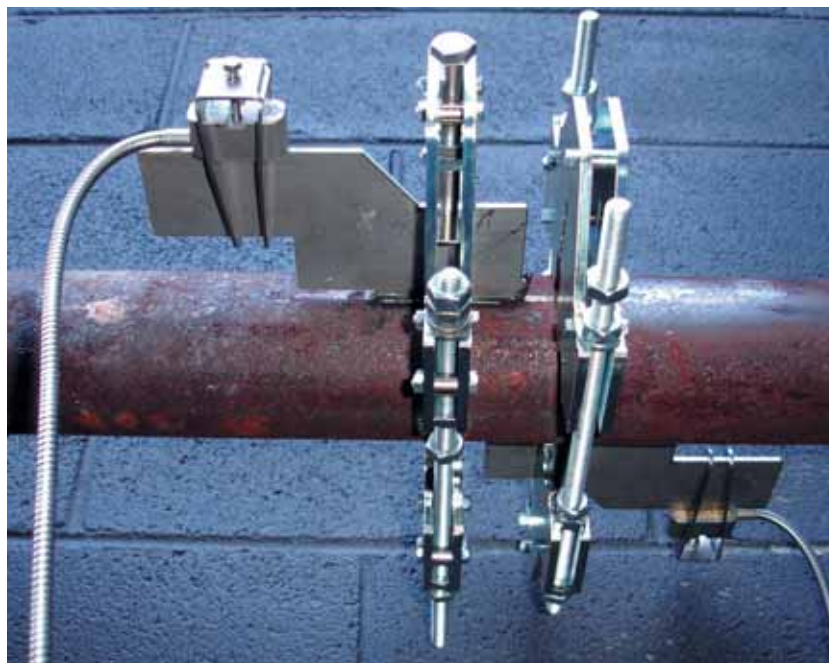
Transducerne sender ultralydssignalet ind i røret via optimerede koblingsfiner. På grund af det store overflade areal, men lille tværsnit, kan disse koblingsfiner aflede det meste af varmeenergien som strålingsvarme og kun en lille del ledes videre til transducerne.
