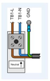
Figure 17: Wiring AC Power Conduit
