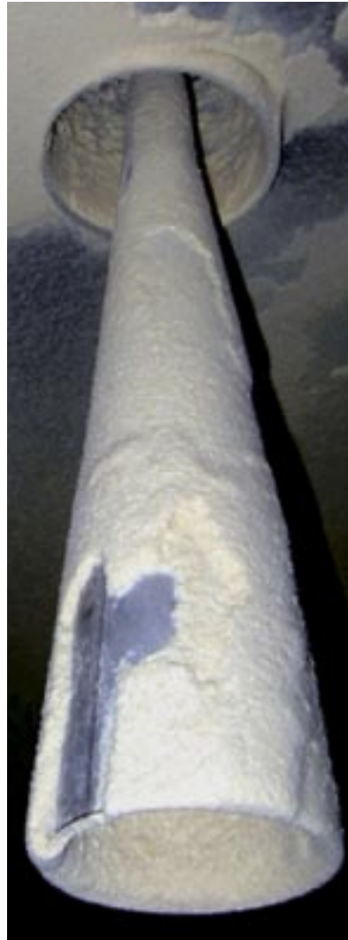
Niveaumåling i støvet miljø. Her har der sat sig meget støv op i antennen, hvilket kan undgås med et støvcover eller trykluftrensning.
